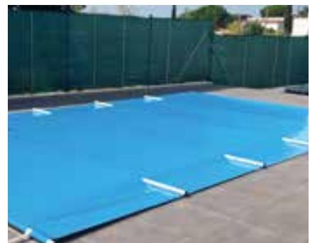
Cobertor de seguretat amb barres d'alumini. Amb PVC armat de gran resistència. Barres d'alumini cada 1,50 m. Recollida mitjançant desmultiplicador amb maneta.
